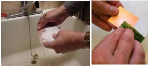
شکل ۱۹-۵- شستشو و تمیز کردن فیبر مدار چاپی
