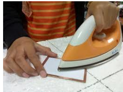
شکل ۱۷-۵- انتقال طرح مدار چاپی به روی فیبر با اتو
