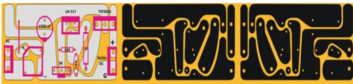
شکل ۲۰-۵- طراحی مدار چاپی و نقشه معکوس مدار چاپی
