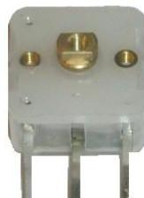
این خازنهای بسیار کوچک اند و در مدارها بكمک پیچ گوشتی می توان آنها را تنظیم کرد. با تغییر دادن فاصله بین صفحات ، ظرفیت خازن تغییر می کند . ماده عایق این خازنهای معمولاً میکا یا سرامیک است . از این خازنهای در فرکانس های بالا استفاده فراوان می شود.
