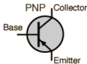
شامل سه لایه نیم هادی که دو لایه کناری از نوع n و لایه میانی از نوع p است. پس از درک ایده‌های اساسی برای قطعه pnp می‌توان به سادگی آنها را به ترانزیستور پر کاربردتر npn مربوط ساخت.
