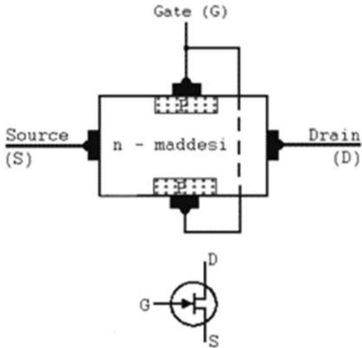
در ترانزیستورهای پیوند اثر میدانی (JFET) در اثر میدان، با اعمال یک ولتاژ به پایه گیتمیزان جریان عبوری از دو پایه سورس و درین کنترل می‌شود. ترانزیستور اثر میدانی بر دو قسم است: نوع n- یا p- ساخته می‌شوند. نواحی کار این ترانزیستورها شامل «فعال» و «اشباع» و «تراپود» است این ترانزیستورها تقریباً هیچ استفاده‌ای ندارند چون جریان دهی آنها محدود است و به سختی مجتمع می‌شوند.
