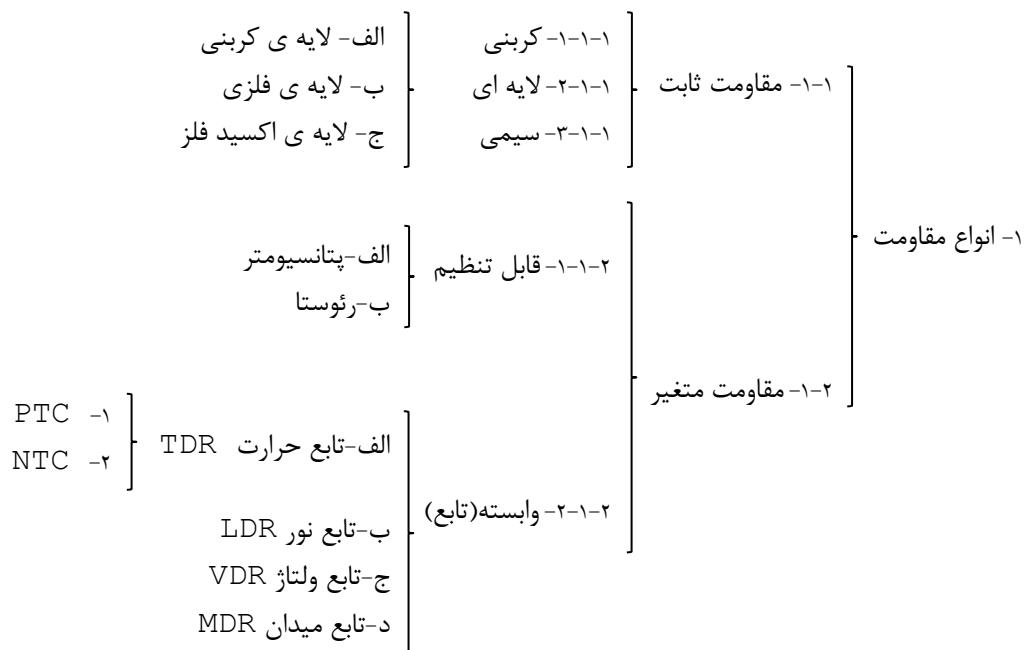
مقاومت جسم هادی دو سری است که در برابر عبور جریان مقاومت می‌کند و ولتاژ دو سر آن متناسب با جریان عبوری از آن می‌باشد.
