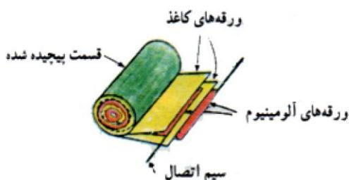
در این نوع خازن به جای آلومینیوم از فلز تانتالیوم استفاده می‌شود زیاد بودن ثابت دی الکتریک اکسید تانتالیوم نسبت به اکسید آلومینیوم (حدوداً ۳ برابر) سبب می‌شود خازنهای تانتالیومی نسبت به نوع آلومینیومی در حجم مساوی دارای ظرفیت بیشتری باشند. محاسن خازن تانتالیومی نسبت به نوع آلومینیومی بدین قرار است :
