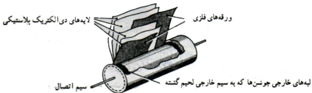
در این نوع خازن از ورقه‌های نازک میکا در بین صفحات خازن (ورقه‌های فلزی - آلومینیوم) استفاده می‌شود و در پایان، مجموعه در یک محفظه قرار داده می‌شوند تا از اثر رطوبت جلوگیری شود. ظرفیت خازنهای میکا تقریباً بین  $0.01\text{--}1\text{ }\mu\text{F}$  فاراد است. از ویژگیهای اصلی و مهم این خازنهای میکا توان داشتن ولتاژ کار بالا، عمر طولانی و کاربرد در مدارات فرکانس بالا را نام برد.
