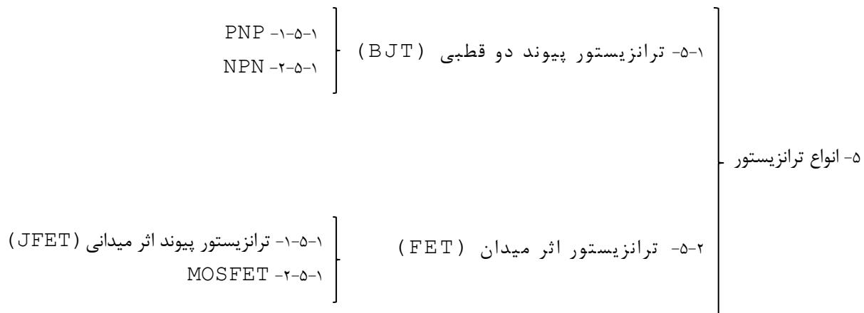
ترانزیستور یک قطعه سه پایه است که ساختار فیزیکی آن بر اساس عملکرد نیمه هادی ها می باشد. ترانزیستور را از دو نوع نیمه هادی با نام سلسیوم و ژرمانیوم می سازند. عموما در یک تقسیم بندی ترانزیستور ها را به دو دسته ترانزیستور های BJT و FET تقسیم می کنند. ترانزیستور های BJT با نام ترانزیستور های پیوند دو قطبی و ترانزیستور های FET با نام ترانزیستور های اثر میدان شناخته شده اند. FET ها دارای سرعت سوئیچینگ کمتر از BJT هستند.
