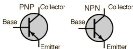
شامل سه لایه نیم هادی که دو لایه کناری از نوع p و لایه میانی از نوع n است و مزیت اصلی آن در تشریح عملکرد ترانزیستور این است که جهت جاری شدن حفره‌ها با جهت جریان یکی است.
