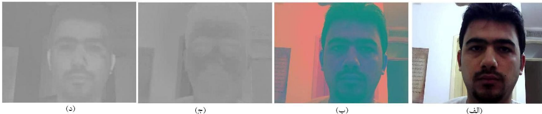
شکل 1: تصویر یک فرد در فضاهای رنگی مختلف (الف) محیط RGB (ب) محیط YCbCr (ج) مولفه ی Cb (د) مولفه ی Cr
