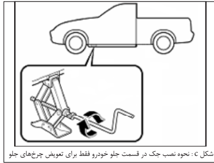
شکل c: نحوه نصب جک در قسمت جلو خودرو فقط برای تعویض چرخ‌های جلو
