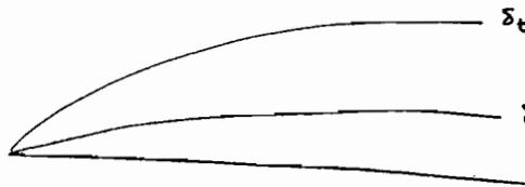
شکل (۳-۵): لایه مرزی حرارتی و سیالاتی در فلزات مایع
