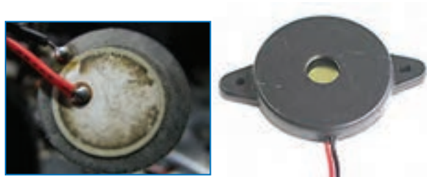
شکل ۹-۲۸ ساختمان داخلی و شکل ظاهری صفحه حساس پیزوالکتریک
