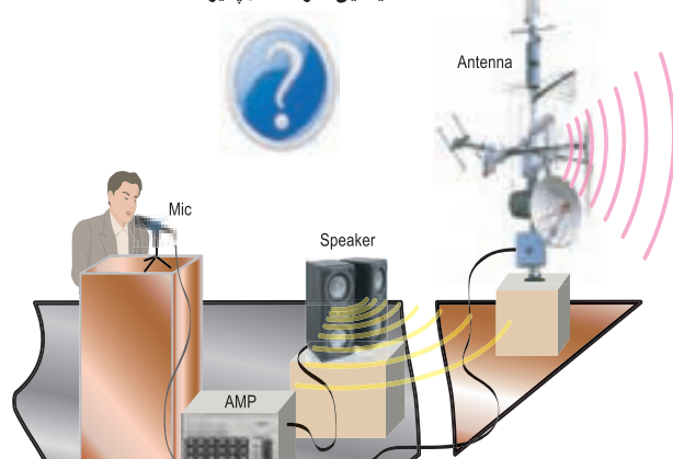
شکل ۳-۷ - تبدیل امواج صوتی به امواج الکترومغناطیسی
