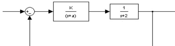
12- مقدار K را در سیستم کنترل زیر برای رسیدن به نسبت میرایی 0,7 بدست آورید.
