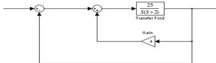
7- (تمرین MATLAB) سیستم حلقه باز با تابع انتقال  $\frac{1}{s^2 + 2\xi s}$  مفروض است. پاسخ خروجی سیستم حلقه بسته فیدبک واحد را به ازای تغییرات  $\xi$  در یک نمودار ترسیم نموده و اثر  $\xi$  را بر روی رفتار سیستم تحلیل نمایید.
