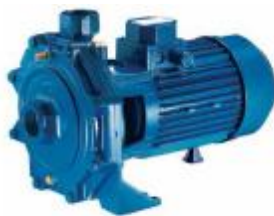
سری CB الکتروپمپ سانتریفیوژ سری CB - دو پروانه بوده و به همین دلیل دارای هد بالاتری می باشد و در ساختمانها کاربرد وسیعی دارند. در انتخاب رایج این نوع پمپ پنتاکس دو پروانه کاربرد می شود.
