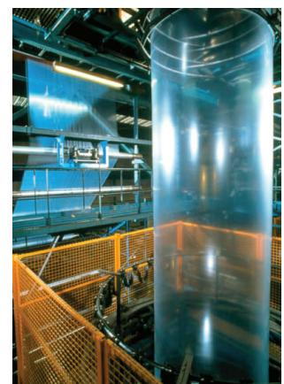
● پلی‌اتن مذاب را در دستگاهی با عمل دمیدن هوا به ورقهٔ نازک پلاستیکی تبدیل می‌کنند.
