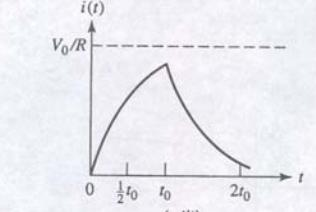
۸-۴۰ دو منحنی پاسخ برای مدار (الف) در شکل (الف)  $\tau$  برابر  $t_0/2$  است. (ب)  $\tau$  برابر  $2t_0$  می‌باشد.
