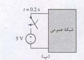
شکل ۸.۲۸ (الف) یک منبع تحریک که راهانداز یک شبکه کلی است. (ب) یک مدار ساده که گنجه کاملاً معادل منبع تحریک مدار (الف) نیست ولی در بسیاری از حالات به عنوان معادل آن به کار می‌رود. (ج) معادل دقیق (الف).
