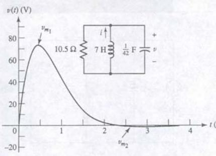
شکل ۹-۲۱ پاسخ زیرمیرای مدار سری RLC با افزایش R، حالات زیرمیرای حاصل می‌شود.
