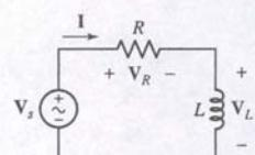
شکل ۱۰-۱۵ مدار  $RL$  سری که ولتاژ فیزوری به آن اعمال شده است.
