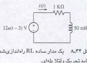
شکل ۸۳۴ یک مدار ساده RL را اندانزی شده با تابع تحریک ولتاژ پله‌ای.
