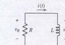
شکل ۸-۱ یک مدار ساده RL که آن باید به ازای شرط اولیه  $I_0 = i(0)$  تعیین شود.
