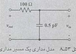
شکل ۸-۵۳ مدل مداری یک مسیر مداری.
