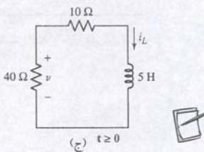
شکل ۸.۵ (الف) یک مدار ساده RL که در  $t = 0$  سوئیچ در آن باز شده است. (ب) مدار قبل از  $t = 0$  و (ج) مدار پس از قطع کلید.
