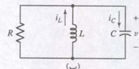
شکل ۹-۲۱ (الف) مدار RLC سری که دوگان مدار RLC موازی (ب) است. مقادیر عناصر دو مدار یکسان نیستند.
