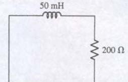
شکل ۸-۲ یک مدار ساده RL که در آن انرژی شرطی در القاگر در  $t = 0$  ذخیره شده است.
