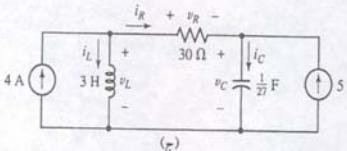
شکل ۹-۲۸ (الف) یک مدار RLC سری که برای نشان دادن تعیین شوابط اولیه به کار رفته است.
