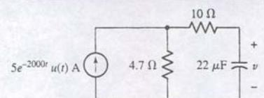
شکل ۸-۴۵ یک مدار ساده RC که با یک تابع نمایی میرا راه‌اندازی شده است.
