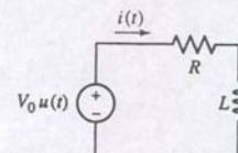
شکل ۸-۳۵ مدار  $RL$  سری که برای نشان دادن روش تعیین پاسخ به صورت مجموع پاسخ‌های طبیعی و واداشته به کار رفته است.
