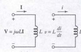
شکل ۱۰-۱۳ القاگر و ولتاژ و جریان آن (الف)
