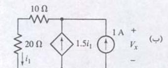
شکل ۸-۲۴ (الف) یک مدار ساده RC حاوی یک منبع وابسته که با ولتاژ یا جریان خازن کنترل نشده است. (ب) مدار معادل تونن شبکه متصصل به خازن.
