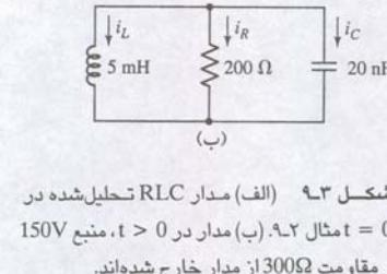
شکل ۹-۳ (الف) مدار RLC تحلیل شده در  $t > 0$ . (ب) مدار در  $t > 0$ ، منبع  $150V$  و مقاومت  $300\Omega$  از مدار خارج شده‌اند.
