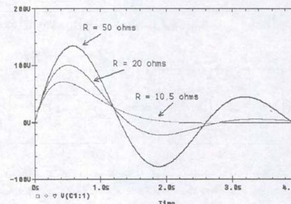
شکل ۹-۲۱ پاسخ زیرمیرای حاصل از شبیه‌سازی به‌ازای سه مقدار مقاومت مقاومت، هرچه R بزرگتر باشد، رفتار نوسانی شدیدتر می‌شود.
