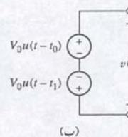
شکل ۸.۳۱ (الف) تابع پله واحد  $u(t-t_0)$ . (ب) متابعی که پالس مربعی  $V_0u(t-t_0)$  را تولید می‌کند.
