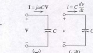
شکل ۱۰-۱۴ (a) رابطه ولتاژ و جریان خازن در (الف) حوزه زمان و (ب) حوزه فرکانس.
