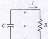
شکل ۸.۱۵ مدار RC موزای که (t) آن باید با شرط اولیه  $v(0) = V_0$  بدهست آید.
