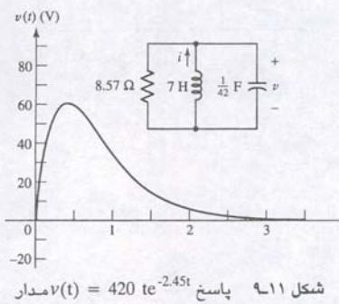
شکل ۹-۱۱ پاسخ  $v(t) = 420 te^{-2.45t}$  مدار شکل ۹-۲ که در آن مقدار  $R$  تغییر کرده است تا پاسخ میرای بحراستی حاصل شود.
