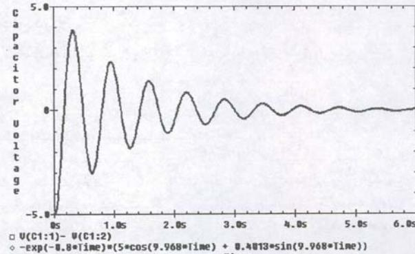
شکل ۹-۲۶ شبیه‌سازی PSpice مدار شکل ۹-۲۵ (الف). هر دو منحنی تحلیل و شبیه‌سازی بر هم منطبق شده‌اند.
