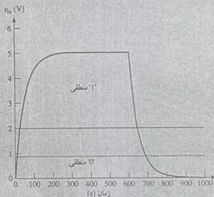
شکل ۸.۵۲ تعیین طرفیت خازنی شارژ/دشارژ مسیر که به ترتیب محدوده ولتاز TTL را برای "۱" منطقی و "۰" منطقی تعیین می‌نماید.
