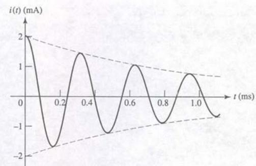
شکل ۹-۲۳ پاسخ جریان مدار RLC سری که در آن  $\omega_0 = 2000\text{s}^{-1}$ ,  $\alpha = 1000\text{s}^{-1}$ ,  $i(0) = 2\text{mA}$  و  $v_C(0) = 2\text{V}$  است. برای رسماً محننی بهتر است ابتدا پوش خطچین را ترسیم کنیم.
