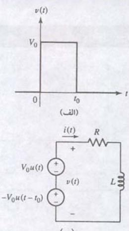
۸-۳۹ (الف) یک پالس ولتاژ مربعی که به عنوان تابع تحریک RL سری به کار رفته است. (ب) مدار RL سری که تابع تحریک آن به صورت ترکیب سری دو منبع ولتاژ مستقل است. می‌خواهیم  $i(t)$  را پیدا کنیم.
