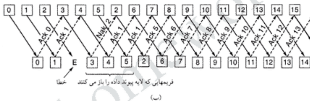
شکل ۳-۱۶. مقابله با خطا در خط لوله. تأثیر خطا وقتی که (الف) اندازه پنجره دریافت گیرنده ۱ است، و (ب) پنجره دریافت بزرگ است.
