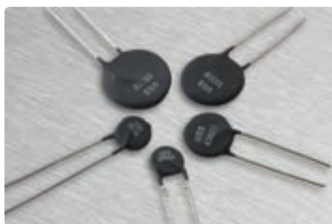
(ب) تصویری از چند ترمیستور دیسکی واقعی
