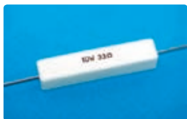
ب) تصویری از یک مقاومت پیچ‌ای
