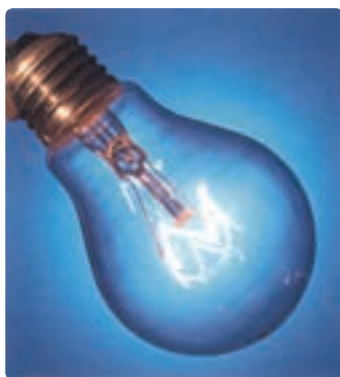
شکل ۹-۳ عبور جریان از فیلامان تنگستنی موجب درخشش لامپ جابی شده است.
