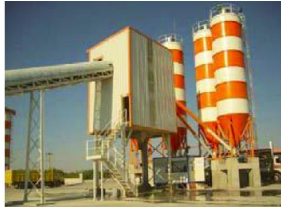
دستگاه بتن ساز
