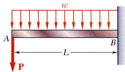
تیر یکسرگیردار  $AB$  بار گسترده یکنواخت  $w$  و بار متمرکز  $P$  را مطابق شکل تحمل می‌کند. اگر  $EI=5\text{MN.m}^2$ ،  $P=6\text{kN}$ ،  $w=4\text{kN/m}$ ،  $L=2\text{m}$  باشد خیز نقطه  $A$  را تعیین کنید.
