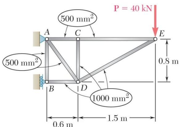
مثال (۹-۸): میله‌های خرپای نشان داده شده در شکل از جنس آلومینیوم با مدول الاستیک  $E=73\text{GPa}$  هستند. خیز عمودی نقطه  $E$  را در اثر نیروی  $P$  تعیین کنید.
