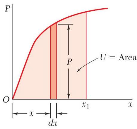
پس کار کل انجام شده بوسیله بار  $P$  هنگامی که میله به اندازه
