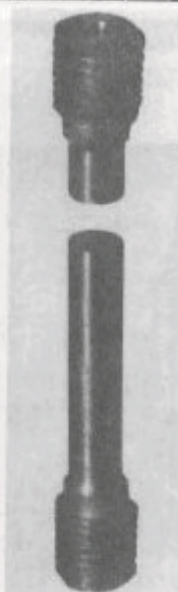
شکل ۱۲-۲ نمونه آزمایش یک ماده شکسته.
