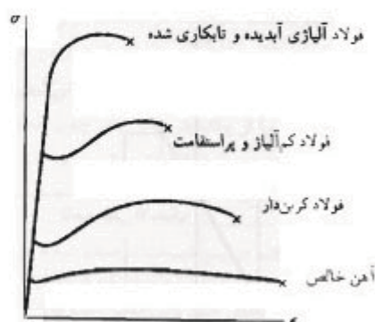
شکل ۲-۱۶ نمودارهای تنش-کرنش برای آهن و فولاد در درجات مختلف فولاد.
