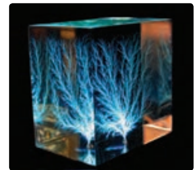
شکل ۳۰-۲ تشکیل مسیرهای رسانشی سرخس‌شکلی در دی الکتریک شده است.
