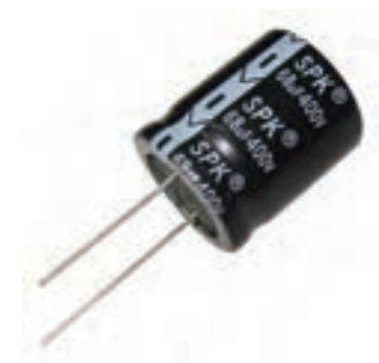
شکل ۳۱-۲ تصویری از یک خازن که روی آن ظرفیت و اختلاف پتانسیل قابل تحمل بیشینه نوشته شده است.
