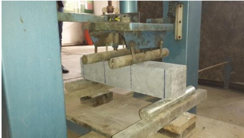
شکل ۲-۱۰ آزمایش تعیین مدول گسیختگی بتن
