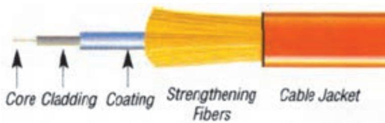
شکل ۸-۴- اجزای تشکیل‌دهنده یک کابل فیبر
