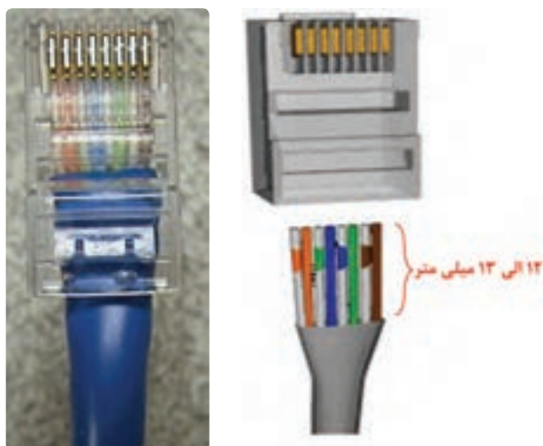
شکل ۴۶- سوکت زدن به سر کابل
