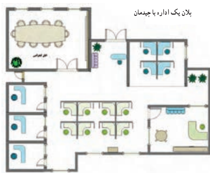
شکل ۱۳-۴- نقشه پلان یک ساختمان اداری با چیدمان آن
