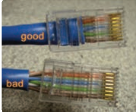
شکل ۴۸-۴- روکش برداری مناسب و نامناسب کابل‌های شبکه
