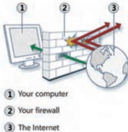
شکل ۷-۱- تصویر عملکرد دیوار آتش
