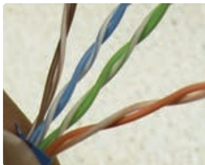
شکل ۴۴-۴- روکش برداری از کابل شبکه
