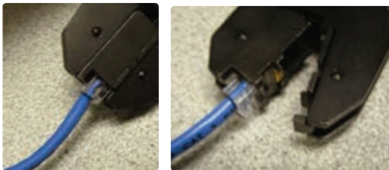
شکل ۴۷- پرس سوکت های کابل شبکه
