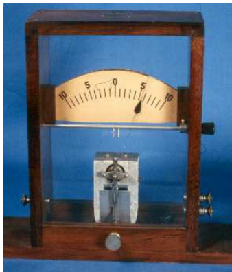
شکل 4-2 - شمای واقعی دستگاه گالوانومتر آرسنوال
