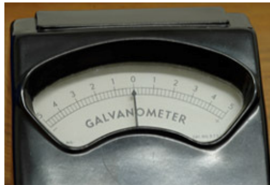
شکل 4-2 - شمای واقعی دستگاه گالوانومتر آرسنوال
