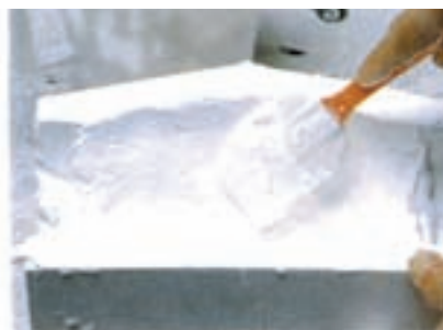
۱۶- گچ را درون قالب یک دست کنید.
