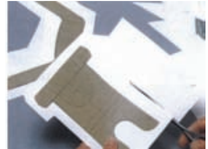
۱- خطوط محیطی الگو روی ورق پلاستیکی رسم می شود.
