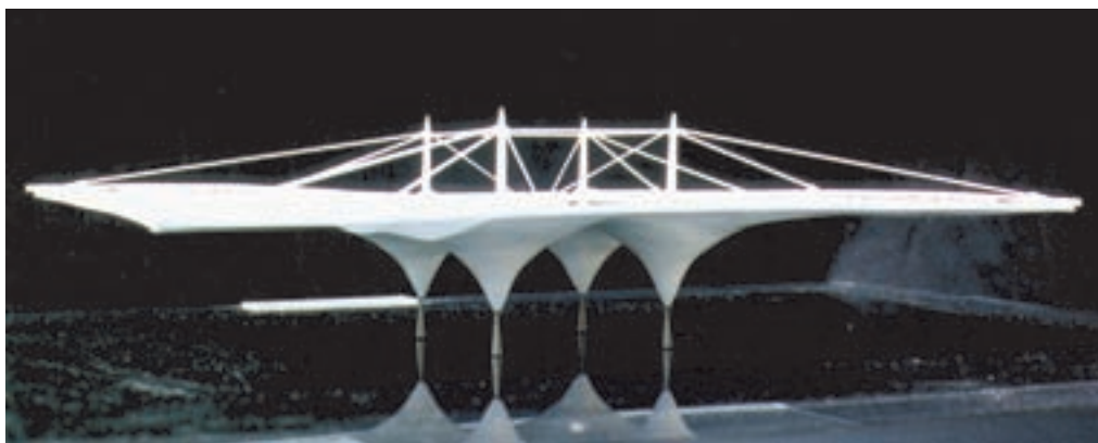
شکل ۳۲- مدل پوسته‌ای با فایبرگلاس
