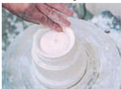
۱۶- سنباده زدن انحنا و نهایی کردن
