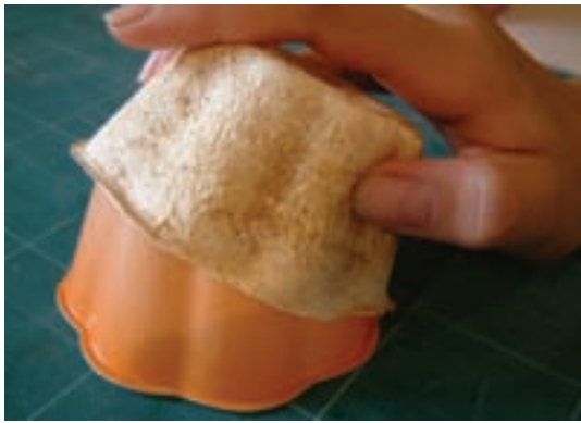
۴- خروج قطعه از روی مدل
