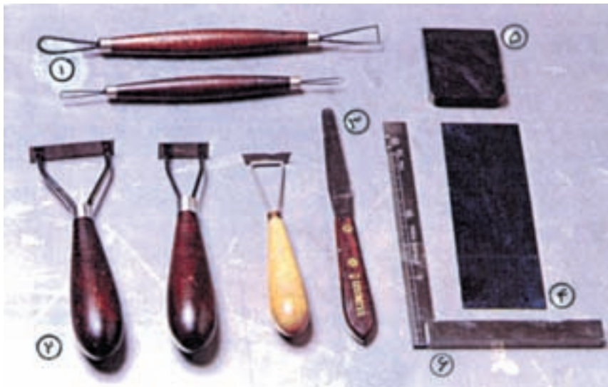
۱- ابزار سیمی برنده گل و خمیر ۲- ابزار تسمه‌ای تراشنده گچ و بالکلی (یک روی آن تیز و روی دیگر آن، اره‌ای شکل است). ۳- کارد مدل‌سازی (برای گذاشتن گچ، گل و خمیر) ۴- لیسسه ۵- لیسسه لاستیکی برای ایجاد قوسهای مختلف ۶- گونیای فلزی
