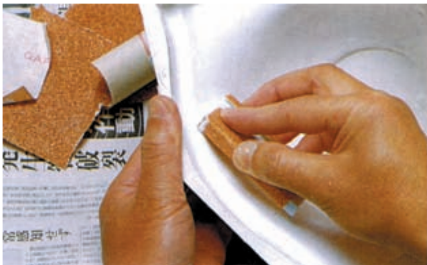
۱۳- زبریه‌های سطح قالب گچی را پس از خشک شدن گچ با سنباده برطرف کنید.
