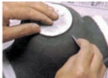
۸- با یک کاردک پلاستیکی دارای انحنای، سطح مدل را صاف کنید.
