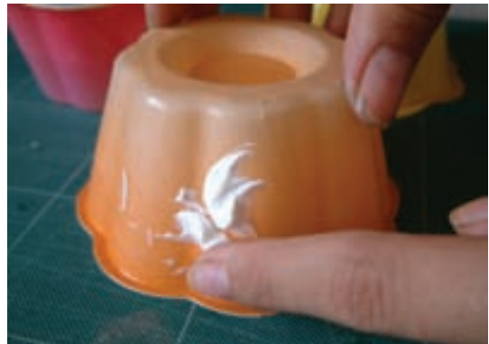
۱- زدن ماده جداکننده به مدل
