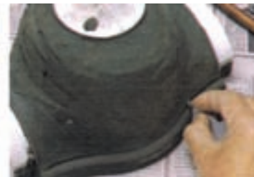
۷- از یک تیغه پلاستیکی به ضخامت یک میلیمتر به عنوان شابلون ۱ لبه گیری مدل استفاده کنید.
