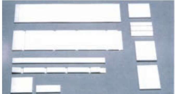
۱- قطعات بریده و زاویه خورده استایروفوم
