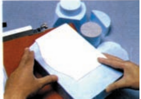
۲- مونتاز قطعات فومی ساخته شده
