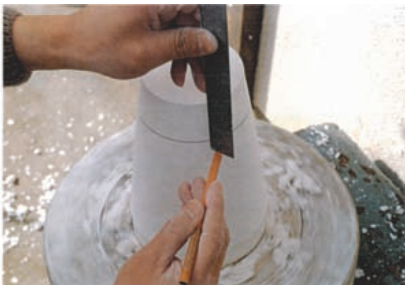
۲- در این مرحله، حد بالای مدل مشخص می‌شود.
