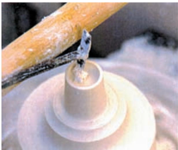
۸- تراش داخلی با استفاده از تکیه‌گاه
