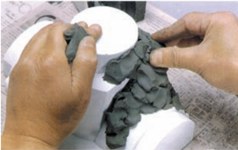
۶- خمیر روغنی (خمیر مجسمه سازی) را با دست به سطح قطعه بفشارید.
