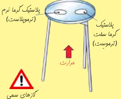
وقتی ماده‌ی گرم‌نرم شُل شد، با استفاده از یک میله‌ی شیشه‌ای، رشت‌های نخ مانند را از آن بیرون بکشید. همچنین می‌توانید ماده‌ی پلاستیکی نرم شده را در یک قالب جدید ریخته و به شکل تازه‌ای در آورید.
