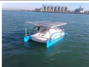
استفاده از انرژی خورشیدی و باتری به عنوان منبع انرژی در قایق ربات خودران به منظور کنترل، حفاظت و پایش عمق پای اسکله ها و حوضچه های بنادر، طراحی شده در دانشگاه تهران
