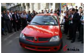
خودروی هیبرید برقی - پیل سوختی دانشگاه خواجه نصیرالدین طوسی این خودرو از طریق ترکیب هیدروژن و اکسیژن در پیل سوختی، انرژی خود را تامین می کند.
