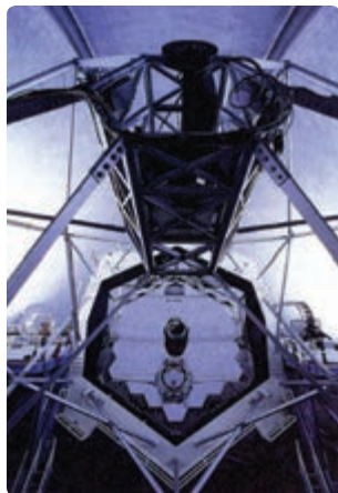
شکل ۵-۴- تلسکوپ کِک در هاوایی. در این تلسکوپ از بازتاب نور توسط تعدادی آینه مقعر استفاده می‌شود.
