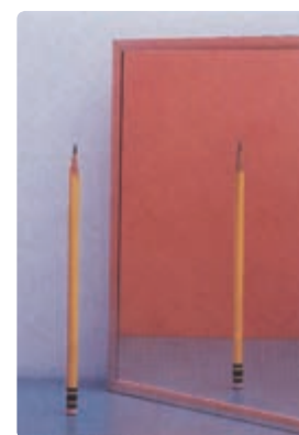
شکل ۴-۱۱- تشکیل تصویر در آینه تخت
