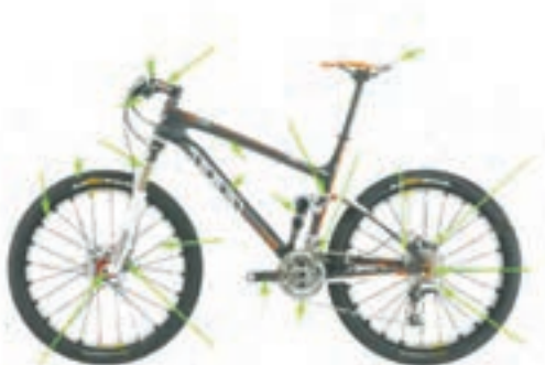
شکل ۳ - دوچرخه از اجزا یا ماشین‌های ساده‌تری مانند: اهرم، پیچ و مهره، چرخ و محور، چرخ و دنده... تشکیل شده است.
