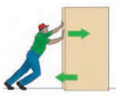
شکل ۲- شخص به جعبه ساکن نیرو وارد می‌کند ولی جعبه حرکت نمی‌کند زیرا نیروی روبه جلو با نیروی اصطکاک رو به عقب هم‌اندازه‌اند.
