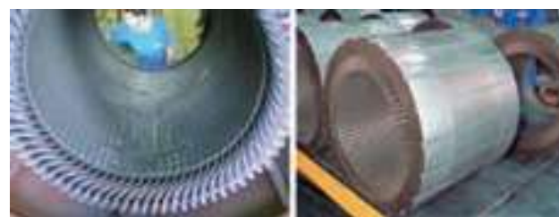
شکل ۳- هسته استاتور، بدنه و سیم پیچ استاتور
