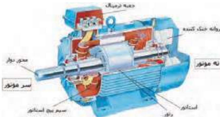
شکل ۲- اجزای تشکیل دهنده یک موتور القایی
