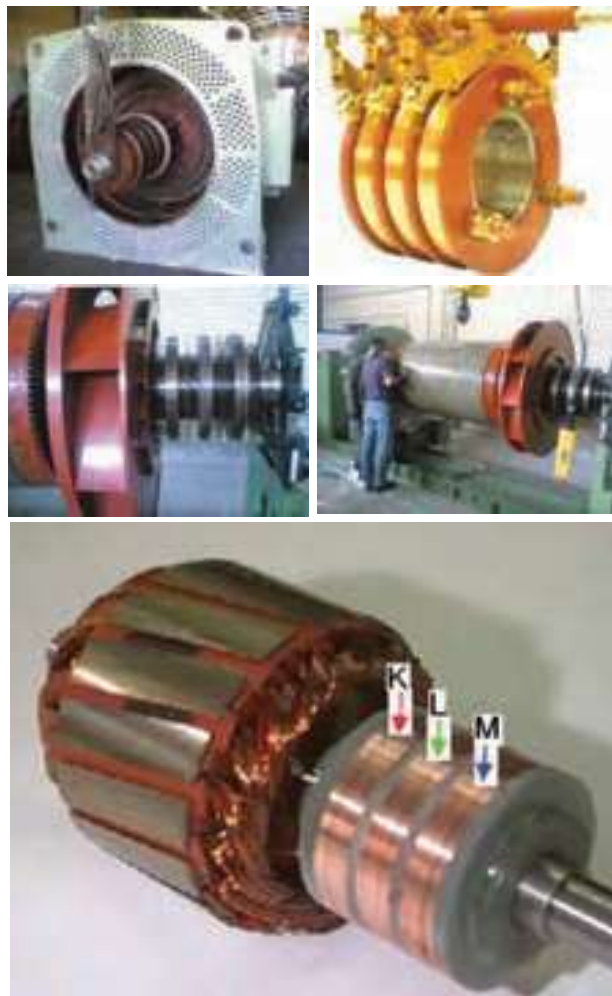
شکل ۸- رتور سیم پیچی شده در ابعاد مختلف
