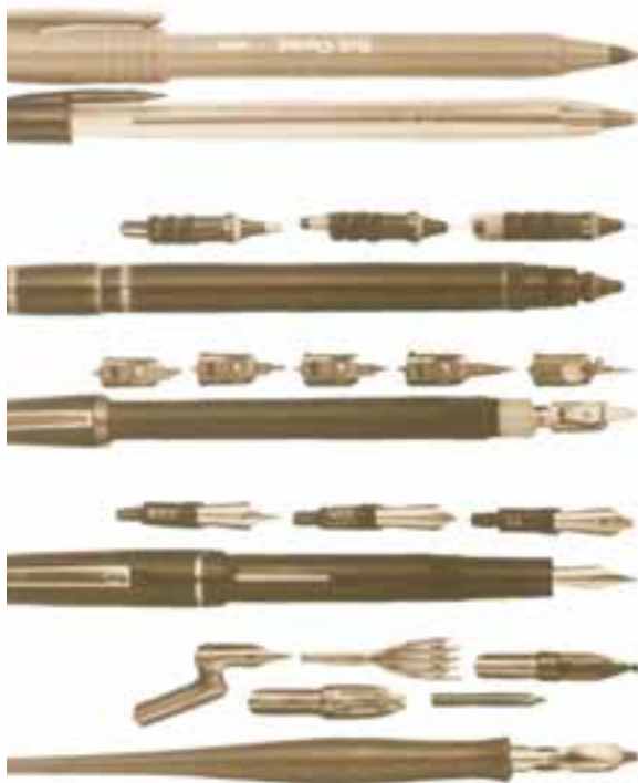
تصویر ۱۳- انواع قلم فلزی، خودنویس، قلم گرافوس، قلم راییدوگراف، خودکار و روان‌نویس را به ترتیب از پایین به بالا نشان می‌دهد.
