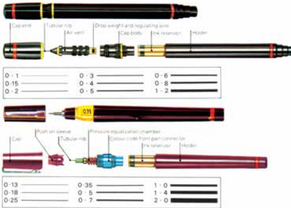
تصویر ۱۷- انواع قلم‌های راپیدوگراف و اجزای آنها را، به همراه خط‌هایی که با ضخامت‌های مختلف توسط شماره‌های مختلف این گونه قلم‌ها رسم می‌شوند، نشان می‌دهد.
