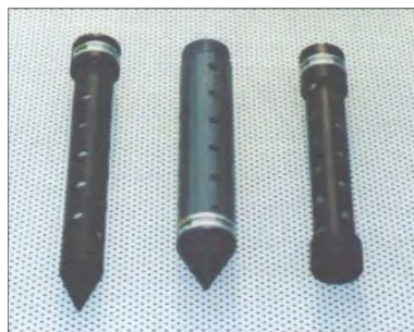
شکل (۱) کاساگرانده، فیلترهایی جهت اندازه‌گیری فشار منفذی آب درون گمانه می‌باشند
