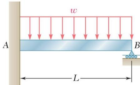
تیر  $AB$  در نقطه  $A$  تکیه‌گاه گیردار و در نقطه  $B$  تکیه‌گاه غلتکی دارد.
