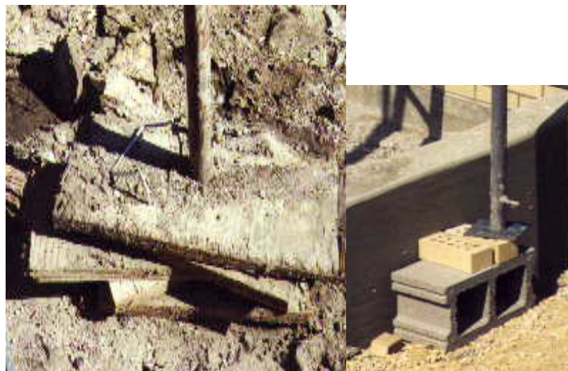
شکل ۲۰- انواع روشهای غیر ایمن استقرار داربست
