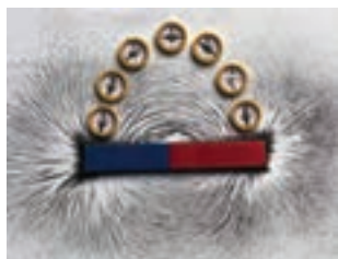
شکل ۴-۹ خط های میدان مغناطیسی در هر نقطه در جهت عقربه مغناطیسی هستند و از قطب N خارج و به قطب S وارد می شوند.
