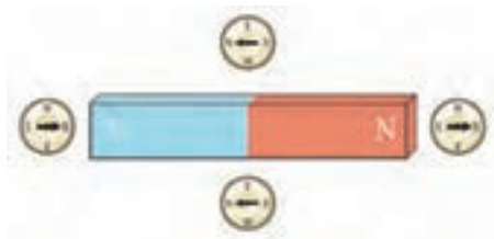
شکل ۴-۸ تعیین جهت میدان مغناطیسی به کمک عقربه مغناطیسی
