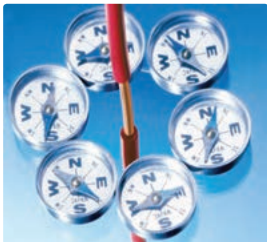
شکل ۴-۱۵ میدان مغناطیسی اطراف سیم حامل جریان را می‌توان با قرار دادن تعدادی عقربه مغناطیسی پیرامون آن نشان داد.
