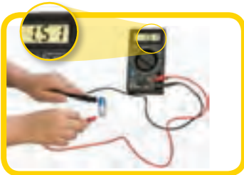
شکل ۶- اندازه‌گیری اختلاف پتانسیل دو سر باتری
