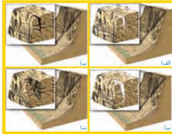
شکل ۳- مراحل هوازدگی سنگ‌ها در اثر یخ زدن آب در درزها و شکاف‌ها الف) یخ زدگی و افزایش حجم ب) ذوب یخ پ) یخ زدگی و افزایش حجم ت) خرد شدن سنگ
