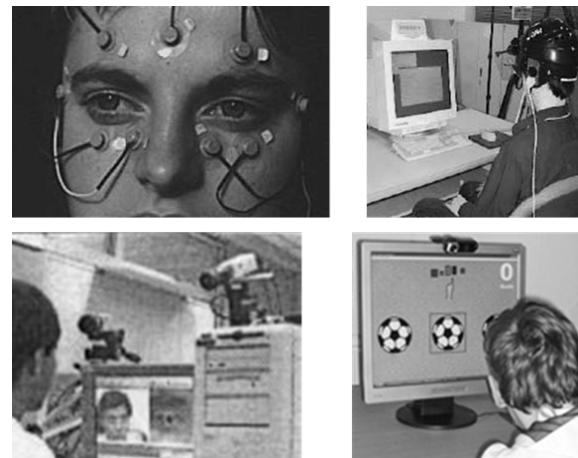
شکل (۱): نمونه‌هایی از سیستم‌های تخمین جهت نگاه در روش‌های مداخله-جویانه (ردیف بالا) و غیر مداخله‌جویانه (ردیف پائین) [۷ و ۱۷]
