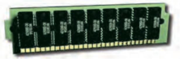
شکل ۷-۳۰- آی‌سی‌های RAM در یک کامپیوتر
