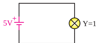
شکل ۳-۳. مدار معادل اثر یک در عمل جمع منطقی (OR)
