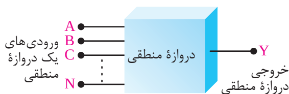
شکل ۱-۱۱ - بلوک کلی یک دروازه منطقی
