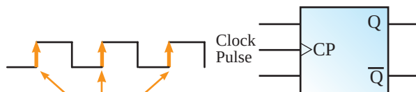
شکل ۵-۲۲ - فلیپ‌فلاپ عامل با لبه بالارونده پالس ساعت
