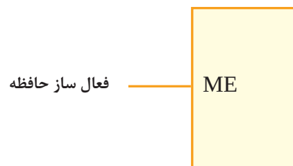
شکل ۷-۲۷- فعال ساز حافظه یک خط کنترل است.
