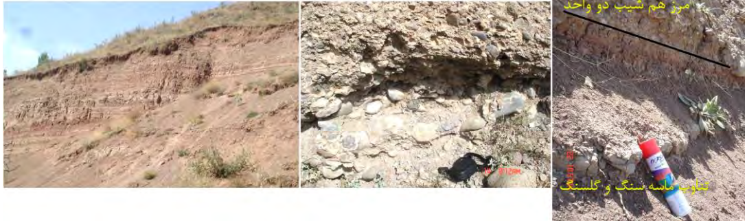
شکل 11: الف- برونزد سنگ های متناوب گلسنگ و ماسه سنگ در نزدیکی محل پل جاده روی آبراهه داخل محدوده ب- مرز بین دو واحد کنگلومرا و تناوب گلسنگ و ماسه سنگ ج- تصویری از برونزد کنگلومرای پلی ژنیک (به ترتیب از چپ به راست)
