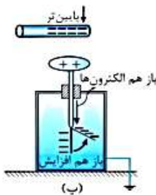
اگر میله را به کلاهک نزدیک کنیم، بار هم الکترون بیشتری از کلاهک به تیغه‌ها منتقل می‌شود (یعنی کلاهک مثبت می‌شود).
