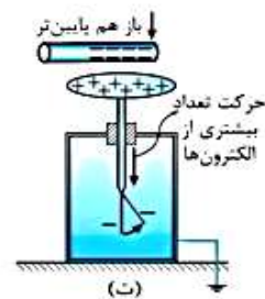
و اگر بار هم میله را بیشتر نزدیک کنیم، تیغه‌ها منفی شده و دوباره از هم دور می‌شوند.
