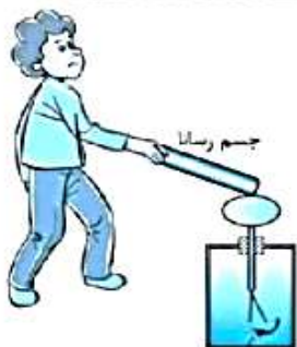
برگه متحرک بلافاصله به تیغه ثابت می‌چسبد.
