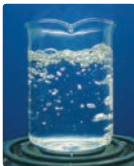
شکل ۴-۲۷ در هنگام جوشیدن، حباب‌ها از محل تشکیل خود به سمت سطح آزاد مایع بالا می‌روند.
