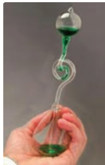
شکل ۴-۴۳ با در دست گرفتن حباب شیشه‌ای و گرم کردن آن، مایع رنگی در لوله ماریچ بالا می‌رود.
