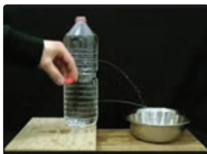
شکل ۱۴-۳ با باز کردن در بطری، آب از سوراخ‌های ایجادشده در بطری، با فشار متفاوت خارج می‌شود. سرعت خروج آب از کدام سوراخ بیشتر است؟
