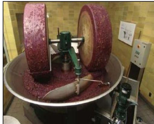
شکل ۳- مرحله خرد کردن ( یک نوع آسیاب سنگی)
