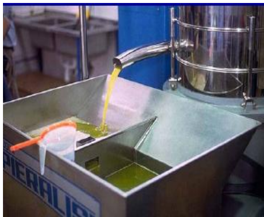
شکل ۸- سانتریفوژ و جدا شدن روغن
