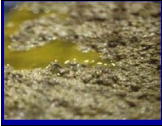
شکل ۶- مالش دادن خمیر و خروج روغن
