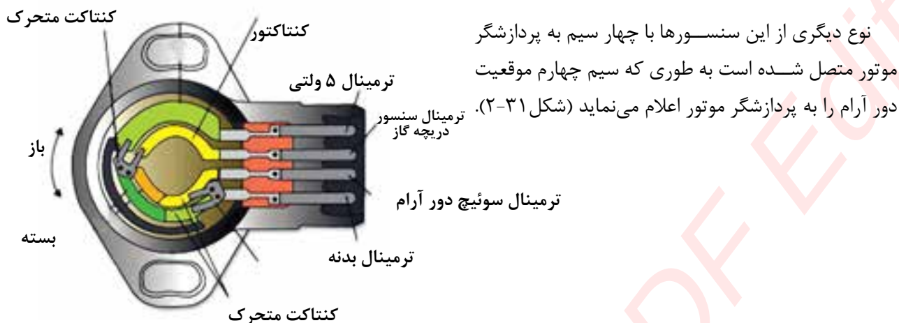
شکل ۲-۳۱- سنسور موقعیت دریچه گاز
