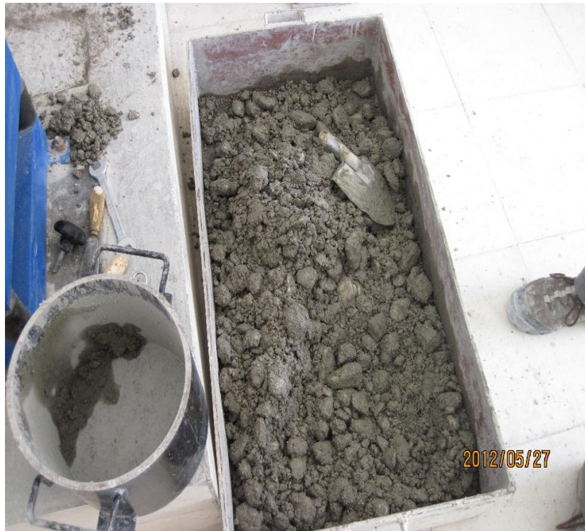
نمائی از بتن غلتکی در آزمایشگاه
