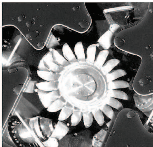
شکل ۲-۳ - شکل چرخ و انژکتور توربین پلتون [۵]
