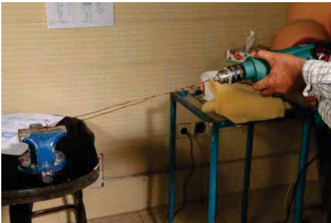
تصویر ۴- طریقه پیچیدن مفتول با دریل
