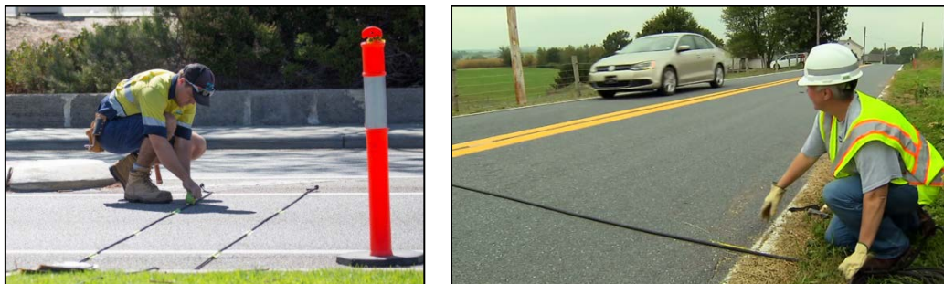
شکل ۵-۵: نمونه شمارگر شاخص هوای فشرده (بادی)
