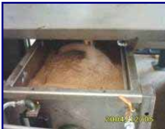
شکل ۶- مالش دادن خمیر و خروج روغن
