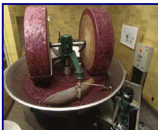
شکل ۴- مرحله خرد کردن ( یک نوع آسیاب فلزی)
