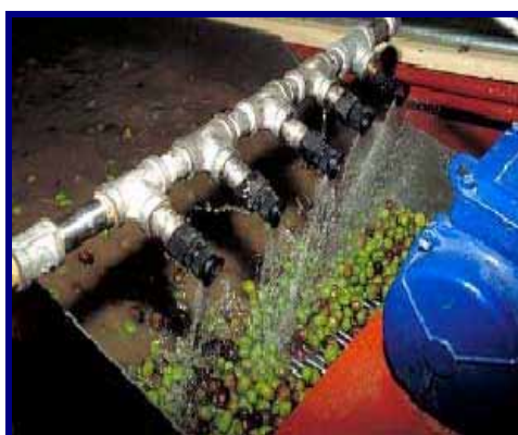
شکل ۲- شستشو با فشار آب
