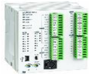
شکل ۲. PLC مدل 2DVP20SX از سری DVP-SX محصول شرکت DELTA ELECTRONICS
