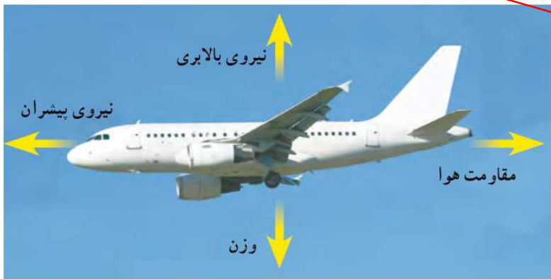
شکل ۶ - وقتی نیروهای وارد بر هواپیما در حال پرواز متوازن باشند، تغییری در حرکت هواپیما ایجاد نمی‌شود.
