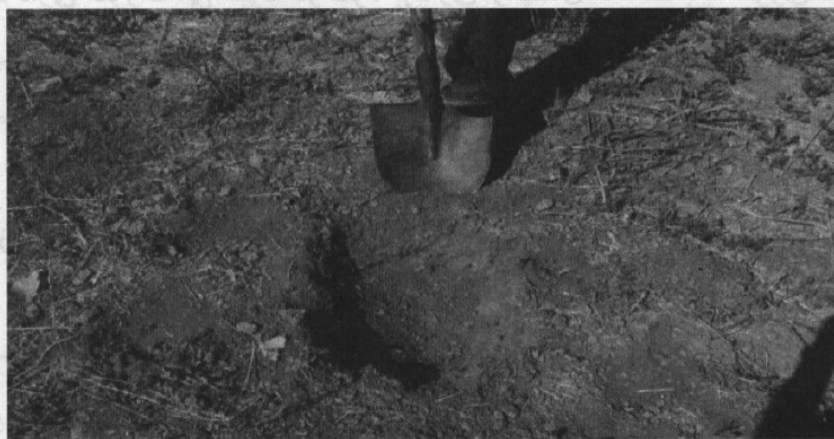
شکل ۲: نحوه نمونه برداری خاک با استفاده از بیل
