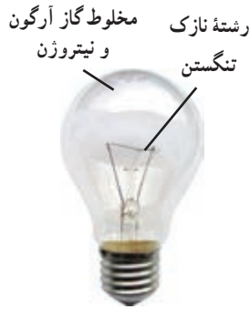
شکل ۳-۲۳- در لامپ‌های رشته‌ای، انرژی الکتریکی، بیشتر به انرژی گرمایی و کمتر به انرژی نورانی تبدیل می‌شود.
