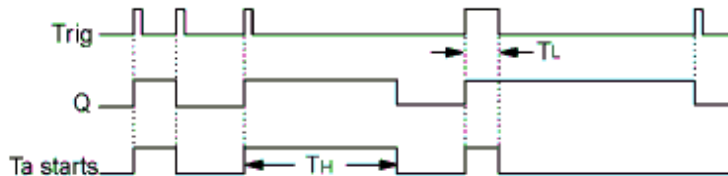
شکل ۶-۵۸: نمودار زمانی عملکرد M multifunctional Switch
