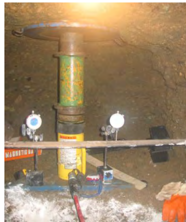
شکل (۵) تصویری از مراحل انجام آزمایش بارگذاری صفحه در لبه ترانشه
